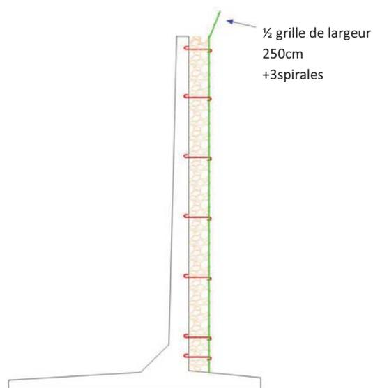
3. Mettre la demi-grille (largeur 250 mm) et la fixer en tête de mur à l'aide des chevilles et fixations fournies par CHAPSOL et des trois spirales sur le dernier panneau.
