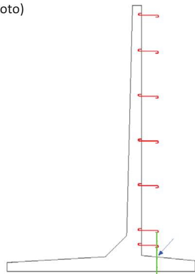
4. Mettre en place deux cales en polystyrène (fournies par CHAPSOL) pour écarter la grille du mur.
