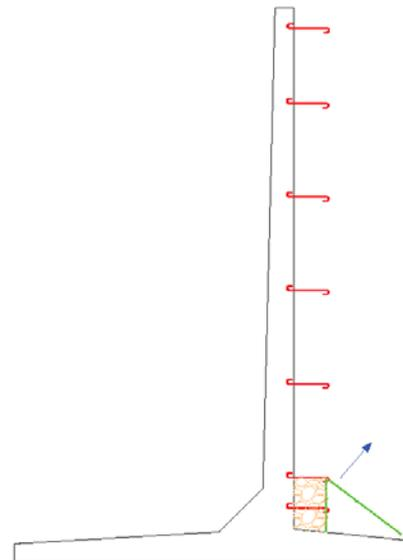
6. Relier les panneaux verticalement au niveau des joints des murs avec des spirales.
